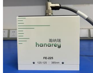
图 12. 将连接线插入发射器
