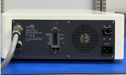
图 11. 将连接线插入控制器
